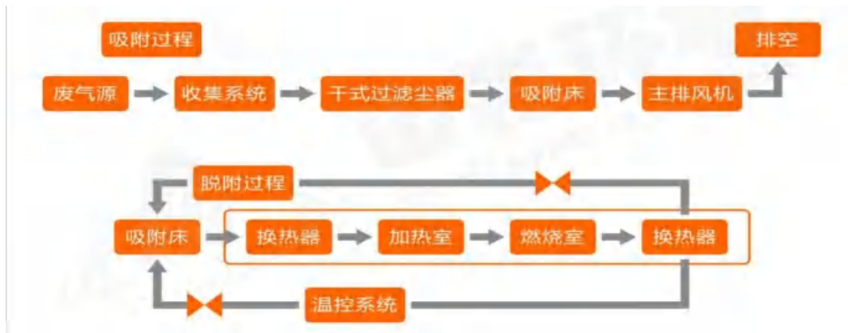
图 7.1-1 废气治理工程工艺流程图
