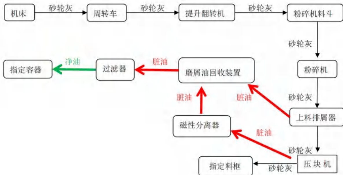
图 7.4-1 砂轮灰脱油流程图
