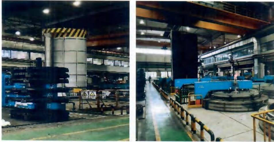
图 2.3-1 热处理油槽淬火工段集气罩
