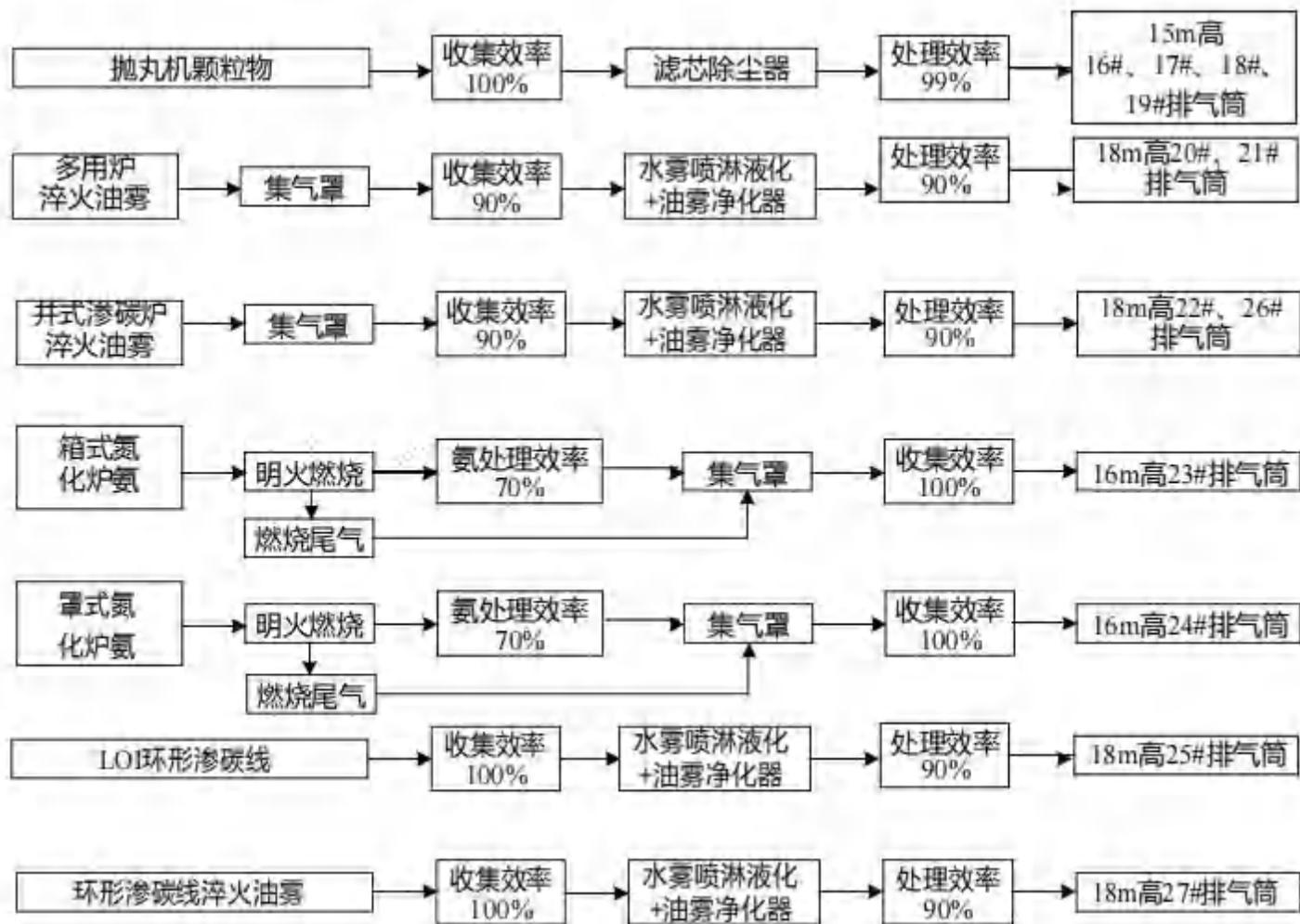
图 1.2.2-6 变动前废气处理排放流程图
