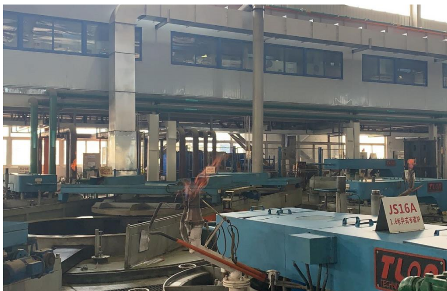
图 4.6-1 井式渗碳炉火炬形式
