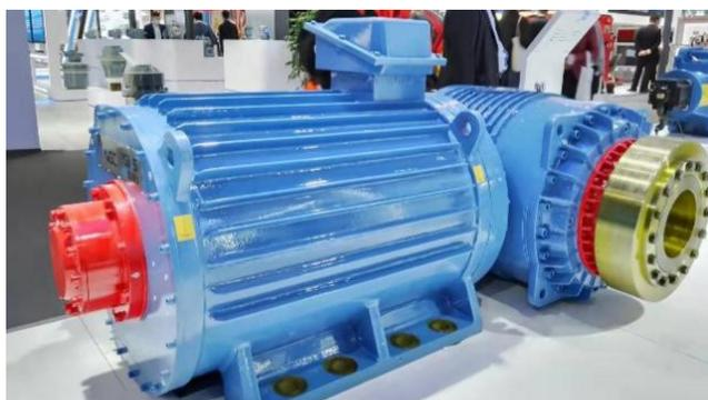
本集團開發機電一體化新產品MGDS永磁-齒輪驅動系統，充分發揮了永磁電機高效率、齒輪傳動高扭矩密度比、變頻系統控制智能化的優勢，同時振動小、重量輕、多驅均載性好、安裝使用簡單，避免了採用聯軸器耦合的傳動損耗，省去了繁瑣的定期軸系調中等維護工作。
